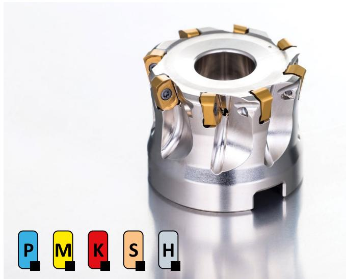
Progresívne frézy SBN10 sú vhodné na väčšinu frézovacích aplikácií, širokú škálu obrábaných materiálov s vysokým posuvom. Jej jedinečná konštrukcia lôžka umožňuje upnúť aj presné doštičky ANHX (DC = 16 - 42 mm) na dokončovanie pri výrobe foriem a nástrojov od rýchleho hrubovania až po dokončenie.
