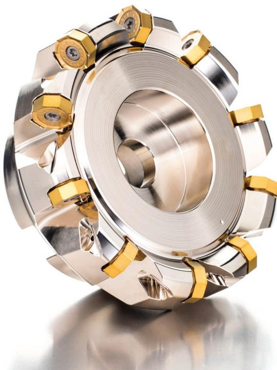
Nová vysoko ekonomická a produktívna čelná fréza využívajúci dva typy obojstranných negatívnych doštičiek. Úsporné osemhranné doštičky ON...06 so 16 reznými hranami a APMX 4 mm a produktívne štvorcové doštičky SN.. 17 s 8 reznými hranami a APMX 7 mm. Rozsah priemerov ( $DC = 50 - 250$  mm) s rozdielnou roztečou zubov. Teleso povrchovo upravené pre dlhšiu životnosť nástroja.
