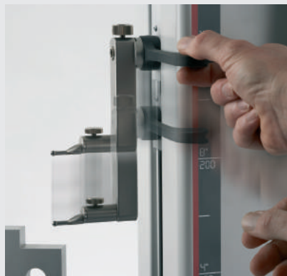
ill. 1. Posuňte měřicími saněmi rukou ve směru měření.
