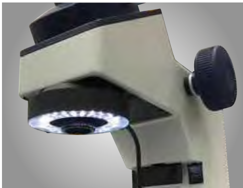
LED kruhové osvetlenie pre aplikácie vyžadujúce osvetlenie zo všetkých strán.
