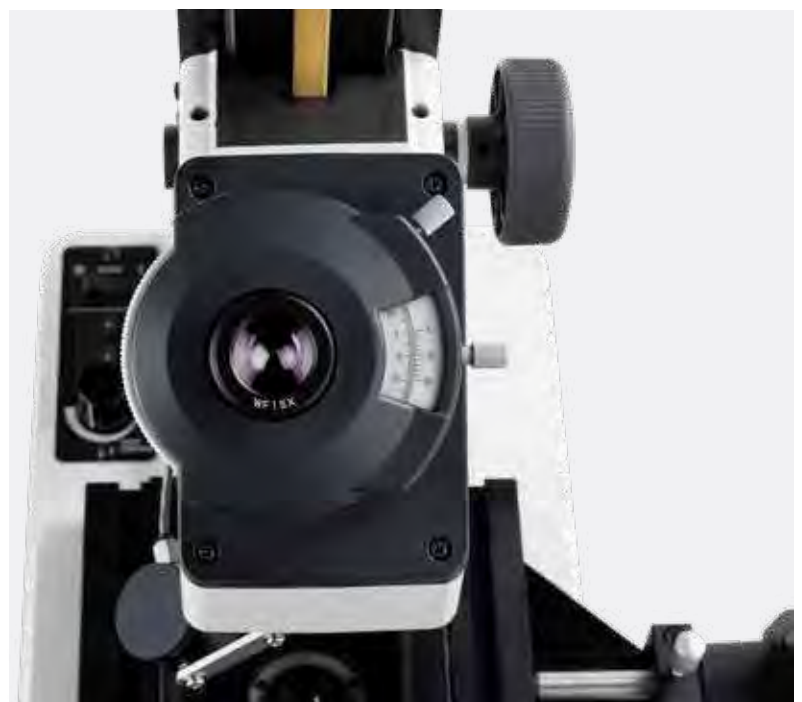
Nóniusová stupnica umiestnená mimo okulára umožňuje jednoduché meranie uhlov.
